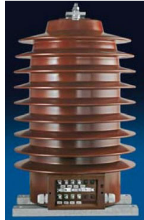
Transformador de tensión para servicio exterior con las pantallas características para extender la línea de fugas
